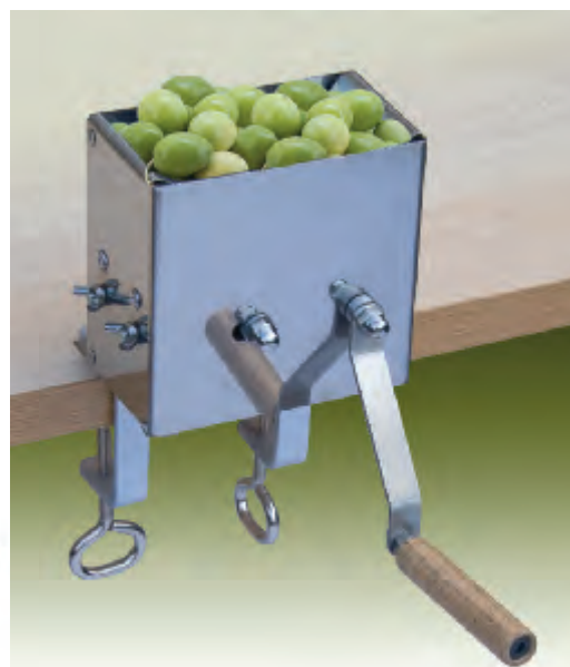
MÁQUINA INOXIDABLE DE RAJAR ACEITUNAS CON SOPORTE (CUCHILLAS INOXIDABLES)
